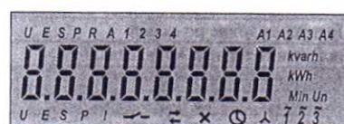
Расшифровка информационных знаков дисплея, используемых в данном исполнении счетчика
